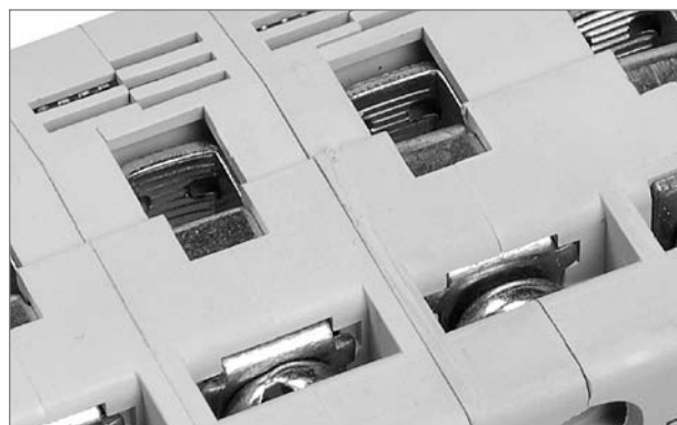
Насечки на контактных зажимах снижают тепловые потери и увеличивают механическую устойчивость соединения.
